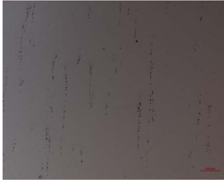
图A. 4 纵条状碳化物标准极限照片（50X）
